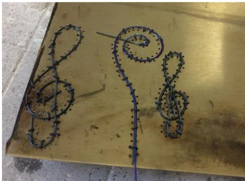
**Obrázek 1:** Matrice se zafixovanými dráty po žihání.
